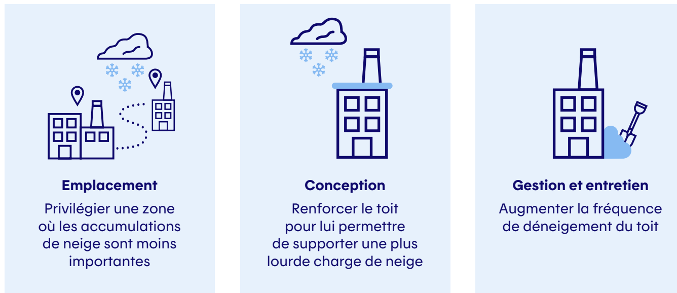
Figure 8 : Exemple de différents types de mesures d'adaptation pour atténuer le risque de charge accrue de neige sur les toits
