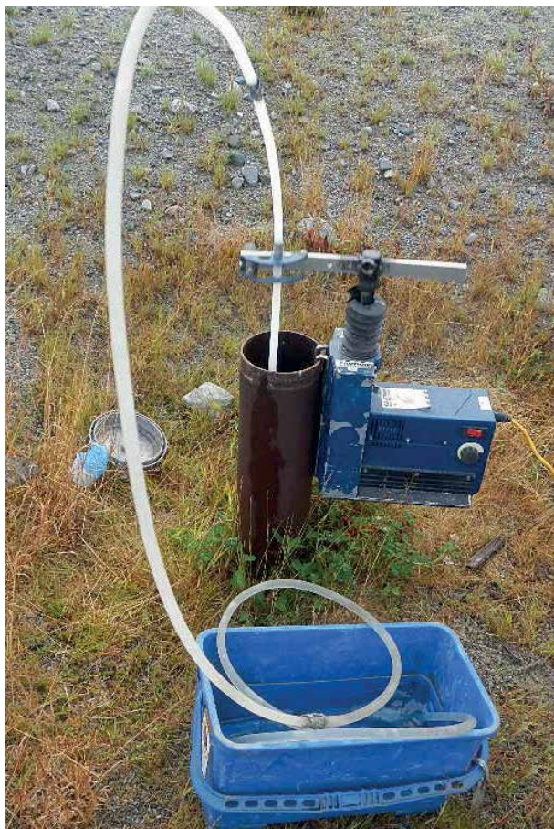
Installation pour le suivi de la qualité de l'eau de la nappe phréatique
