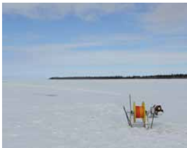
Traction d'un géoradar par treuil électrique
