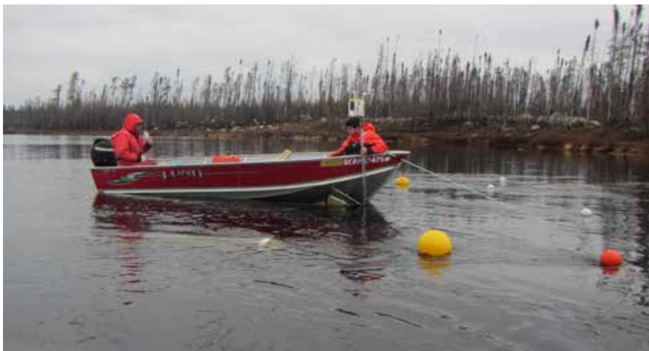
Mesure de la vitesse d'écoulement près de deux filets de dérive installés sur la frayère de la Lemare
