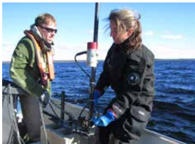
Mise à l'eau d'un sonar à balayage latéral au lac Cabot
