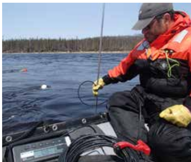
Mesure de la vitesse d'écoulement sur la frayère multispécifique aménagée au PK 314 de la Rupert
