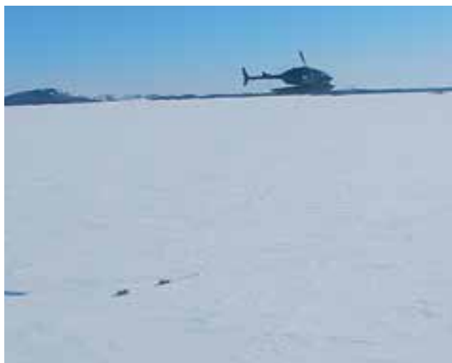
Traction d'un géoradar par hélicoptère
