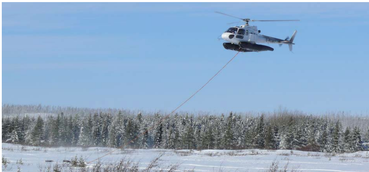
Traction du géoradar par hélicoptère
