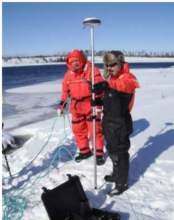
Relevé à l'aide d'un appareil GPS de type RTK (18 mars 2011)
