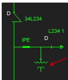
Des disjoncteurs de ligne situés entre le départ de ligne et l'IPE peuvent également être adaptés ou conditionnés pour recevoir la production de l'IPE. Les disjoncteurs de ligne adaptés ou conditionnés sont identifiés dans les *Dispositions spécifiques de l'IPE*.
