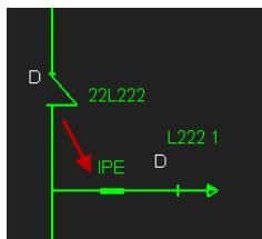
Un disjoncteur de départ conditionné possède un détecteur de présence de tension qui inhibe sa fermeture lors de présence de tension en aval. Ce conditionnement est représenté au schéma CED comme suit :
