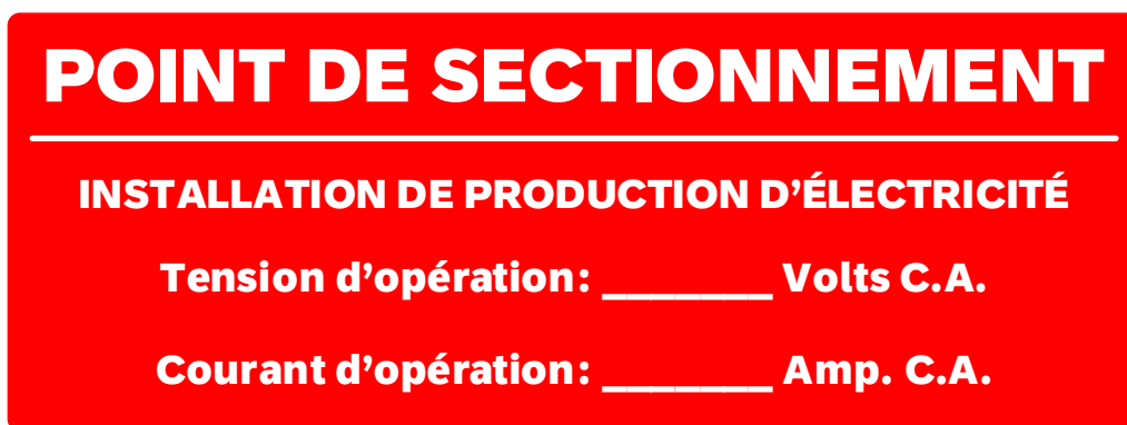
Figure 4 : Avertissement à apposer sur point de sectionnement de l'IPE
