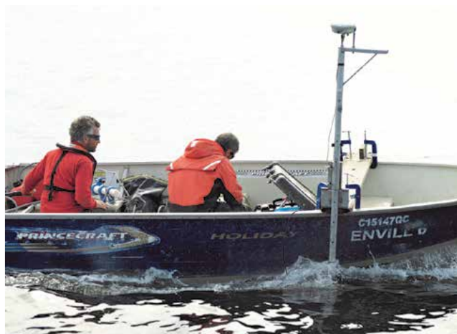
Échosondeur monofaisceau installé dans une embarcation aux fins de relevés bathymétriques de la zone d'étude
