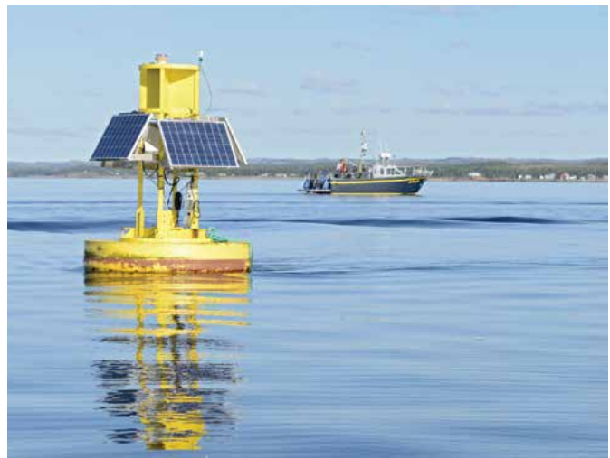
Bouée instrumentée dans la zone de l'embouchure de la Romaine (station P1) mesurant plusieurs paramètres physicochimiques et météorologiques
