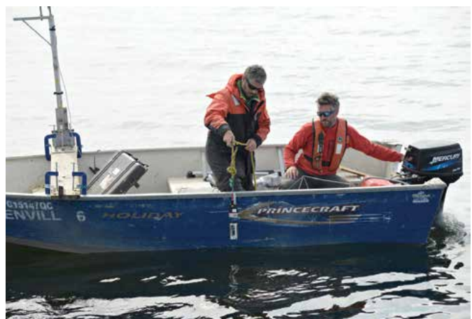
Profilage de la colonne d'eau au regard de la salinité, de la température et d'autres paramètres dans la zone de l'embouchure de la Romaine
