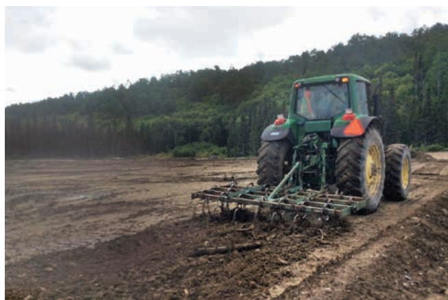
Mélange des boues aseptisées au sol à l'aide d'un équipement agricole de type herse à disques
