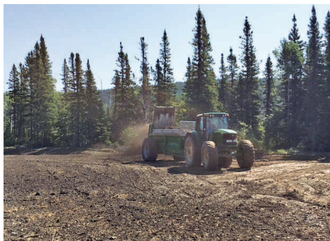
Épandage de boues aseptisées au moyen d'un épandeur à fumier
