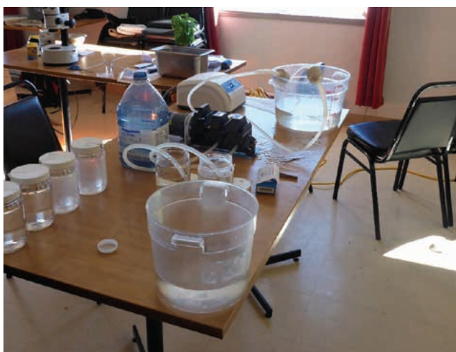
Système de filtration des échantillons d'eau au laboratoire de terrain aux fins de l'analyse de l'ADNe
