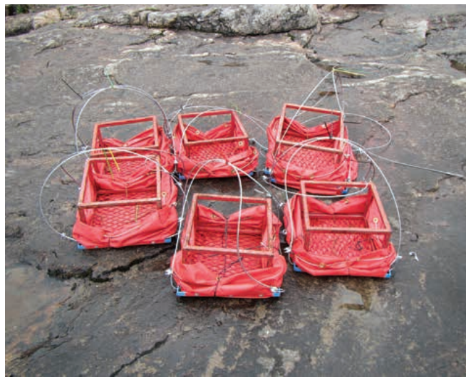
Cubes d'infiltration avant leur installation dans le substrat des frayères
