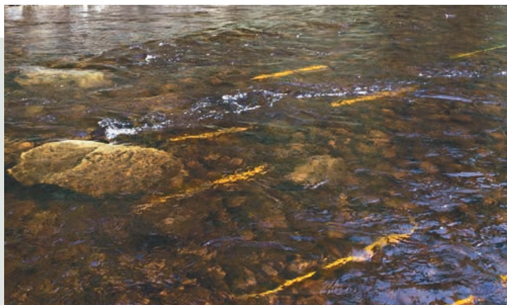
Antennes télémétriques immergées avant leur enfouissement dans l'aire d'élevage amont aménagée au PK 49 de la Romaine
