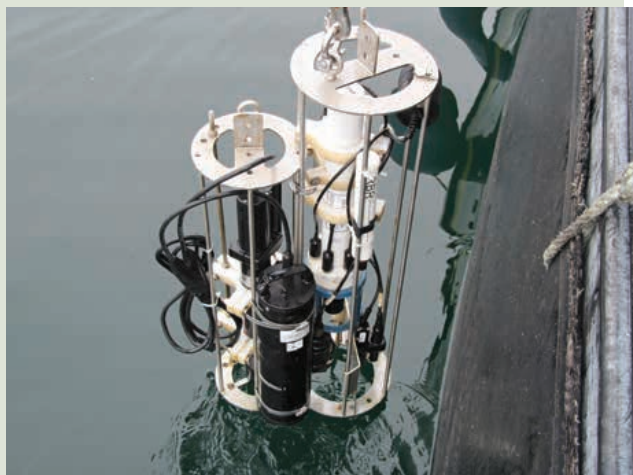
Sonde utilisée pour le profilage physicochimique
