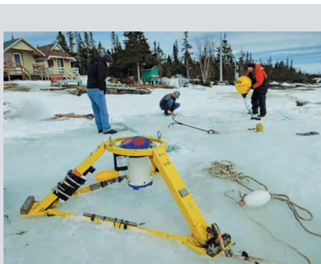
Montage d'une sonde multiparamètre et d'un courantomètre avant leur installation à l'embouchure de la Romaine (avril 2015)
