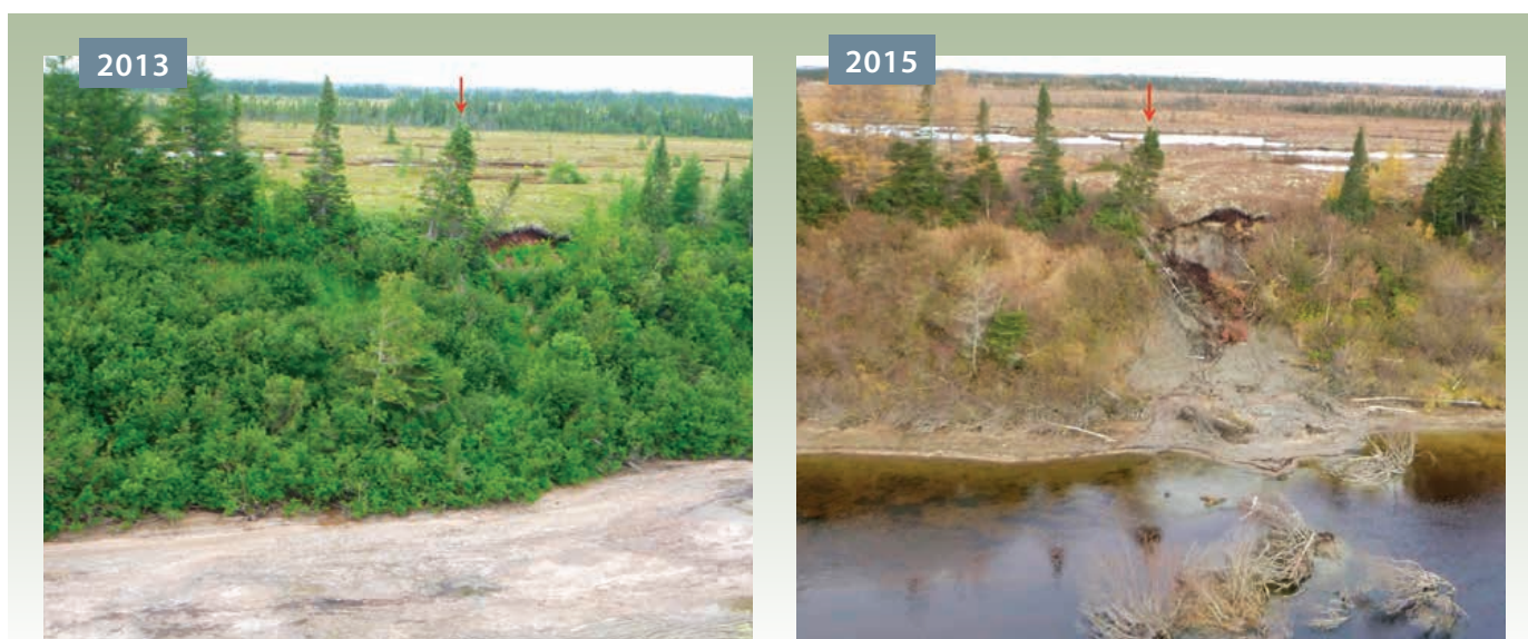
Reprise de l'érosion le long d'un segment de rive partiellement stabilisé en 2013 (PK 21 de la Romaine, rive droite). La flèche pointe vers un arbre ayant constitué un point de repère pour les deux années de suivi.
