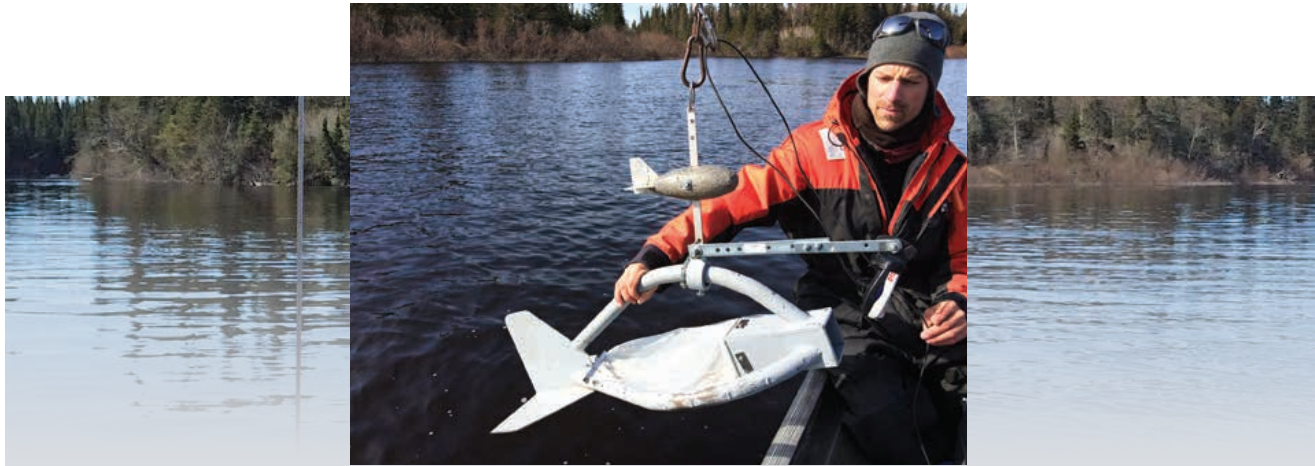
Échantillonnage de la charge de fond à l'aide d'un appareil de type Helley-Smith
