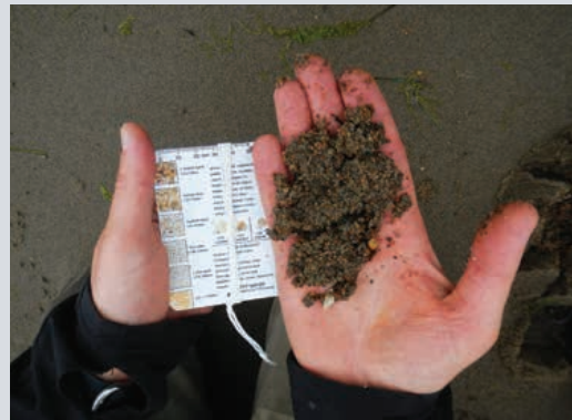
Méthodes d'analyse du substrat par analyse visuelle (au moyen de l'abaque Sand-Gauge) et par échantillonnage (à l'aide d'une benne Ponar)
