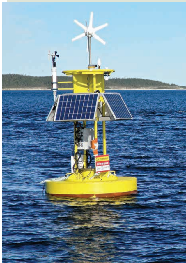
Bouée instrumentée utilisée pour les mesures en continu de la production planctonique
