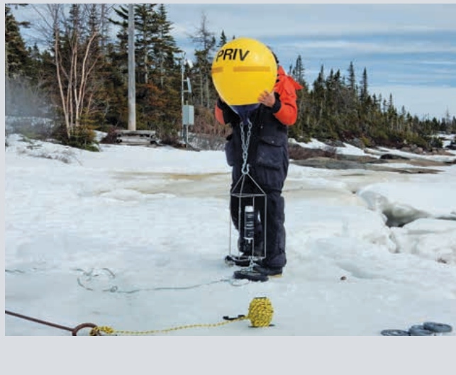
Montage d'une sonde multiparamètre et d'un courantomètre avant leur installation à l'embouchure de la Romaine (avril 2015)
