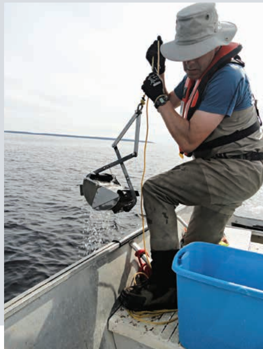
Méthodes d'analyse du substrat par analyse visuelle (au moyen de l'abaque Sand-Gauge) et par échantillonnage (à l'aide d'une benne Ponar)
