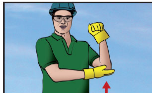
Treuil auxiliaire Taper le coude avec la main
