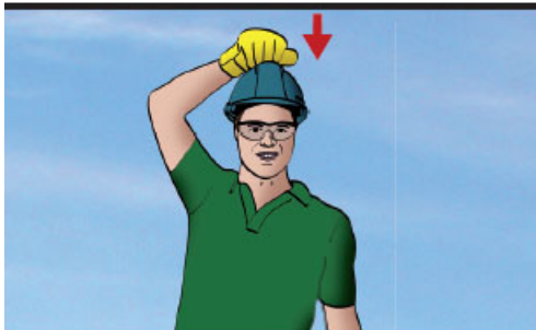
Treuil principal Taper la tête avec le poing
