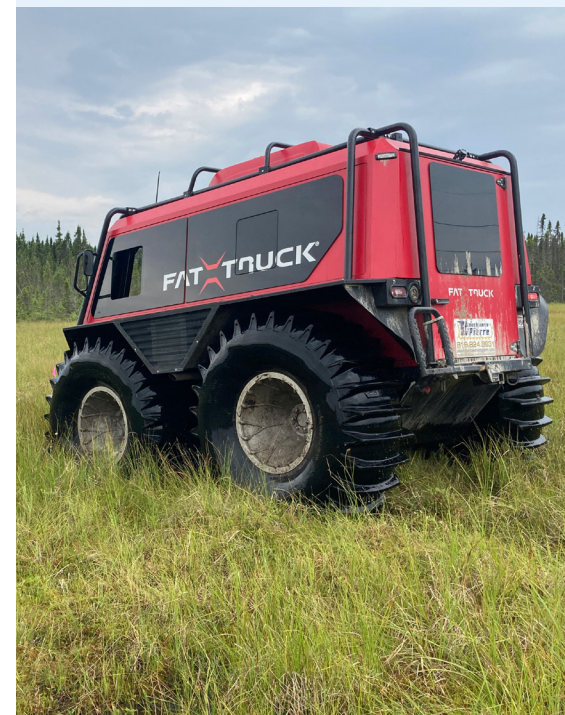
Nouveau type de véhicule utilisé dans les emprises de lignes de transport pour limiter les impacts de la circulation sur les milieux humides
