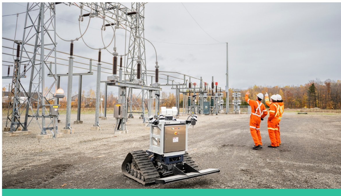
Robot RIAUPEL (robot d'inspection automatisée des postes électriques), fait partie de plusieurs solutions technologiques d'Hydro-Québec. Un article y est consacré dans l' HydroPresse de décembre 2022.
