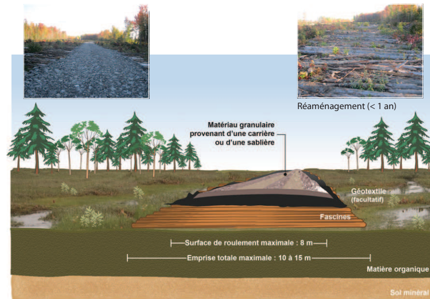
Figure A.5 : Chemin en remblai sur fascines
