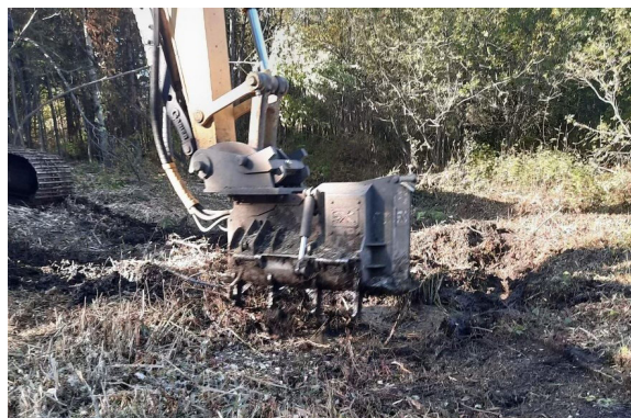
Réparation d'ornières avec la tête déchiqueteuse de la machinerie.
