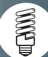
Elle consomme quatre fois moins d'électricité que l'ampoule à incandescence. Et pas de gaspillage de chaleur ! Son tube en tire-bouchon contient de la vapeur de mercure. Quand cette vapeur est excitée par le courant électrique, elle émet des **rayons ultraviolets (UV)**. Ces rayons sont invisibles, mais la paroi de l'ampoule est enduite d'une **substance fluorescente** qui absorbe l'énergie des rayons UV et produit de la lumière visible.
