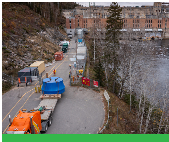
Transport d'une roue du groupe turbine-alternateur de Trois-Rivières à Rapide-Blanc
