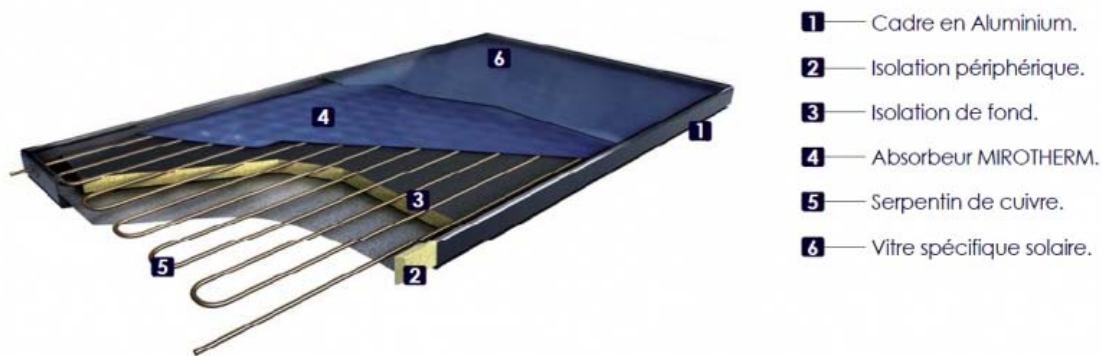
Figure 2-6 : Composantes principales d'un capteur solaire plat (vitré, à circulation de fluide).
