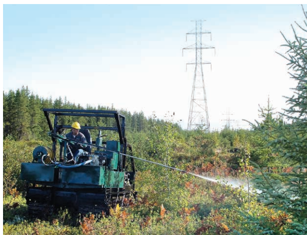
Pulvérisation à fort débit de phytocide sur le feuillage et les tiges
