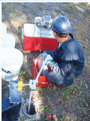
Forage et échantillonnage d'un puits d'observation dans une cour d'un CAS
