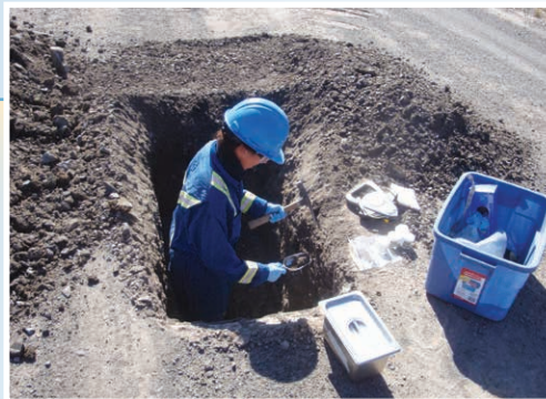
Échantillonnage de sols dans une tranchée dans un poste
