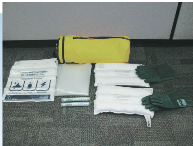
Trousse d'intervention en cas de déversement accidentel pour les véhicules de service des monteurs de ligne de transport
