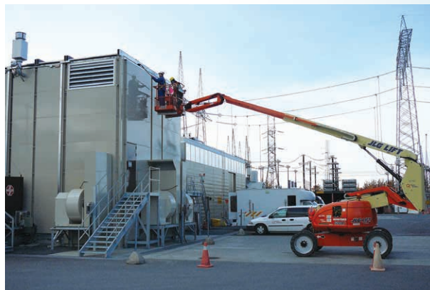
Mesure de l'efficacité acoustique des enceintes acoustiques des compensateurs synchrones du poste de Lévis
