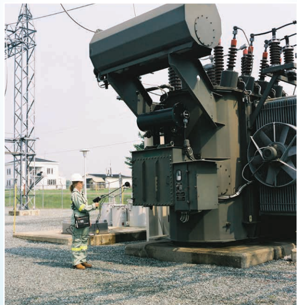
Mesure du bruit d'un transformateur de puissance au poste de Bromptonville
