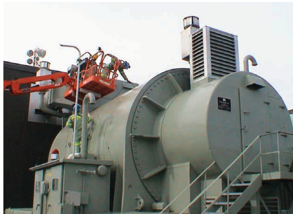
Mesure de l'intensité acoustique d'un compensateur synchrone au poste de Lévis
